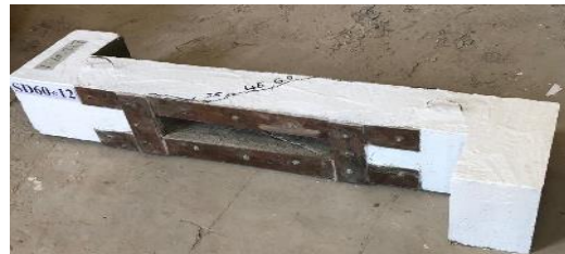
(d) Crack pattern for SD60x12
