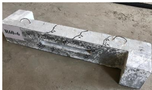
(d) Crack pattern for R60*6
