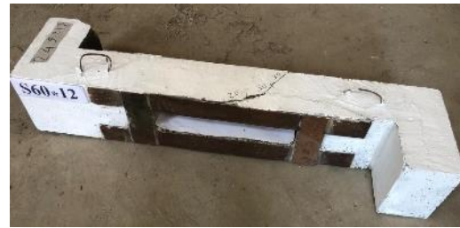
(d) Crack pattern for S60x12
