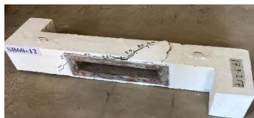
(d) Crack pattern for SB60x12
